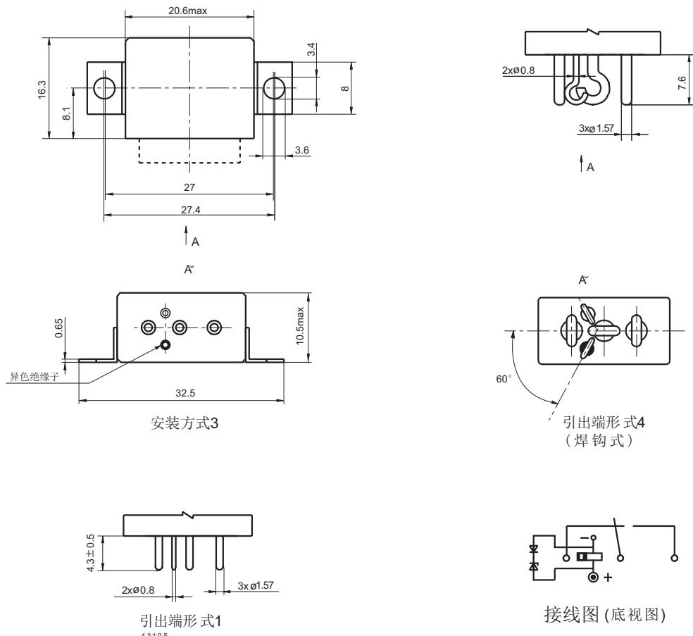
注: 1、可提供螺柱安装方式, 螺柱安装方式只适用于环境等级 I 、 II 。
