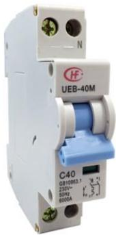
UEB-40 系列小型断路器主要用于交流 50Hz/60Hz，额定电压为 230V，额定电流不超过 40A 的线路中，用来对建筑物和类似场所的线路设施和电气设备进行过电流保护，亦可用于不频繁的通断操作。
